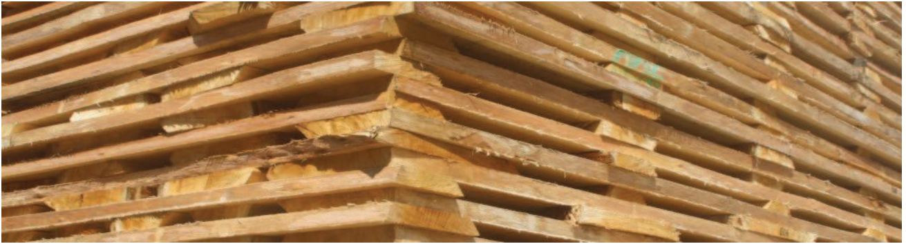
Figura 4.2 - Desenho esquemático de empilhamento para secar madeira serrada http://www.madeidura.com/procedimentos-industriais/serragem-da-madeira
