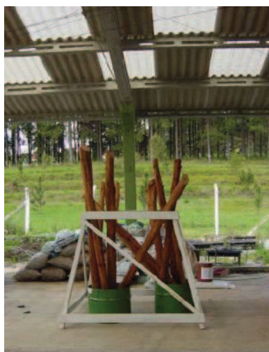
Figura 4.5 - Tratamento por substituição de seiva
