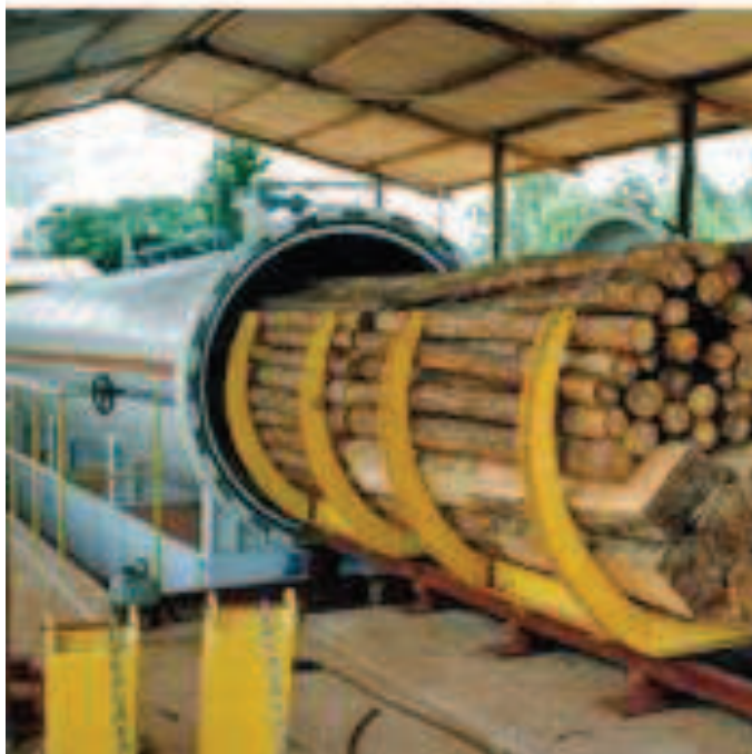
Figura 4.4 - Autoclave de preservação de madeira com pressão
